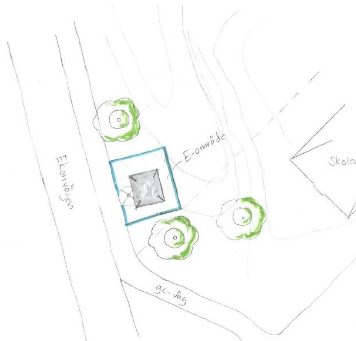
Bild 10. Principskiss över föreslagen placering av ny nätstation strax öster om Ekorrvägen inom fastigheten Ingenjören 12.
